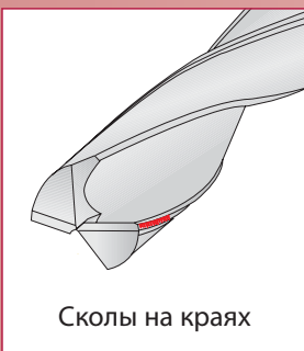
Быстрый износ режущих углов
