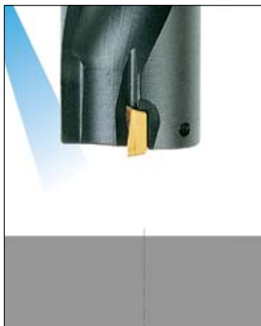
Внешнее охлаждение Глубина сверления ограничена 1,5xD. Для больших глубин - цикл с периодическим выводом сверла.
